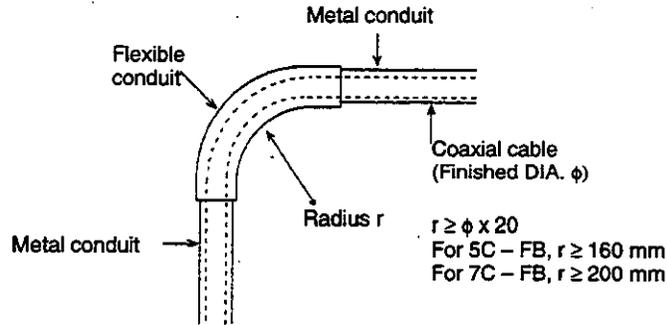
Figure 6.5 Metal Conduit Bending
