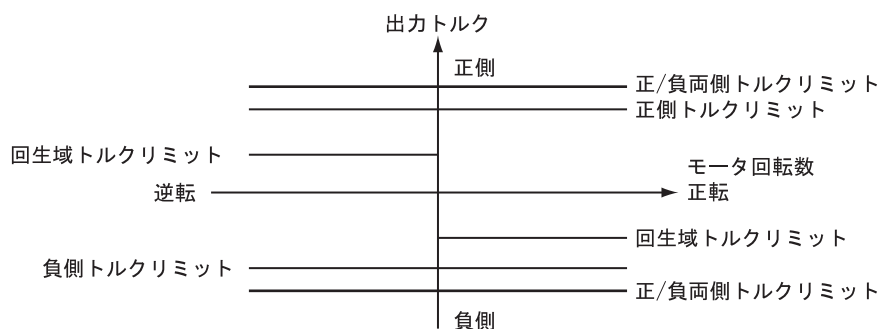
図 6.38 アナログ入力によるトルクリミット
