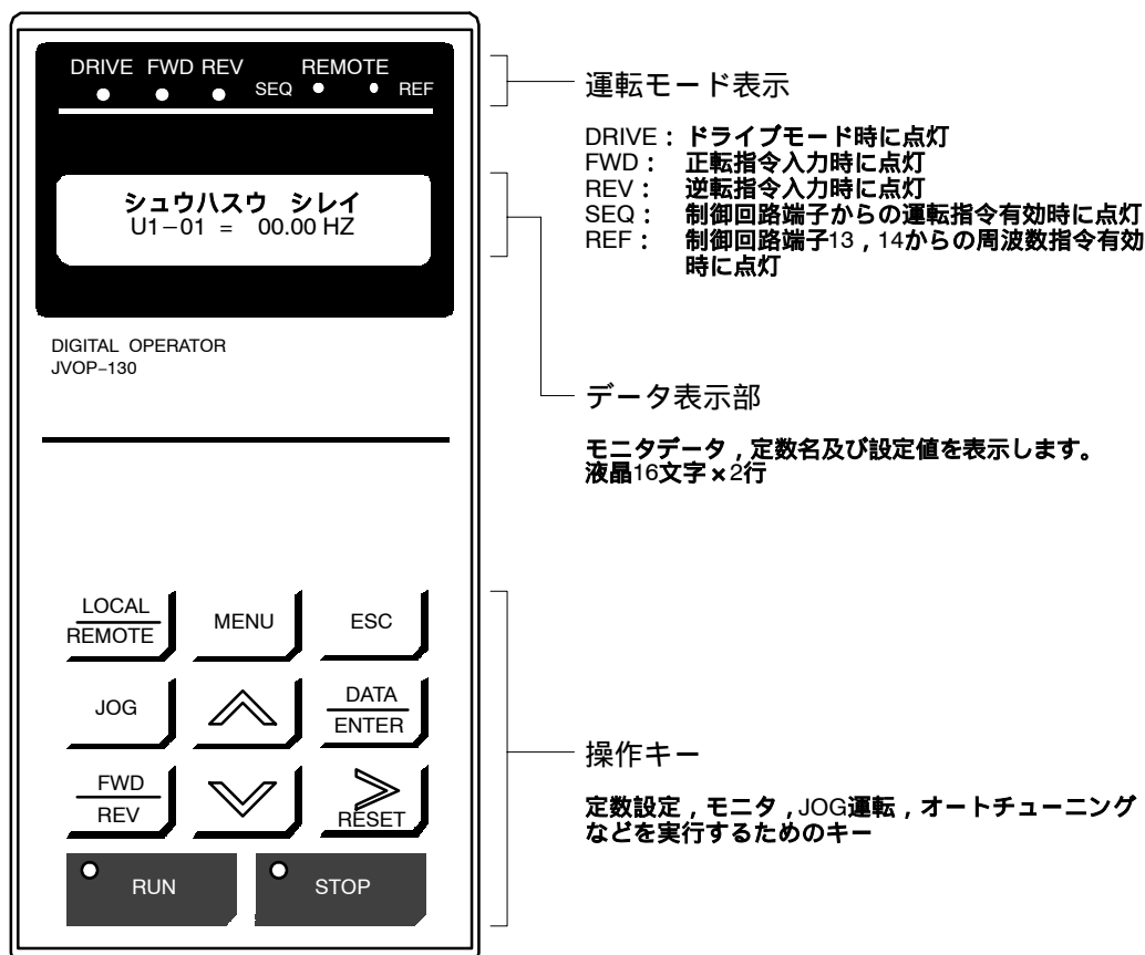
図4.1 デジタルオペレータ（オペレータ）の各部の名称と機能
