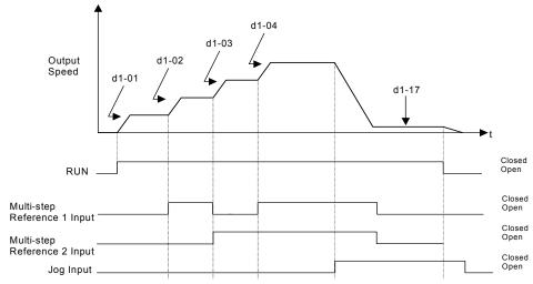
Fig. 25. Preset Reference Timing Diagram
