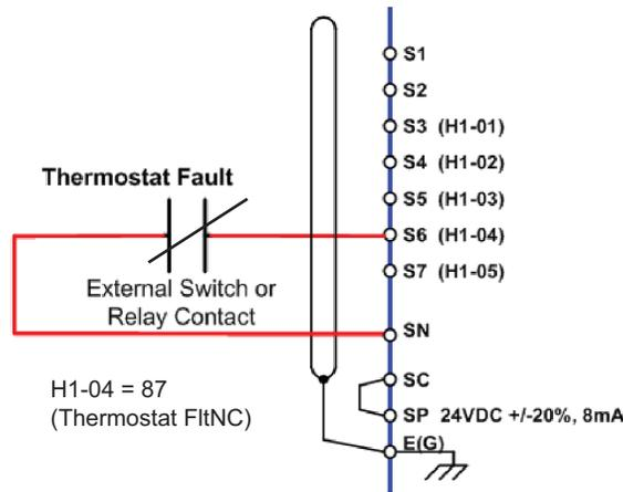
**Figure 51 Wiring Diagram**
