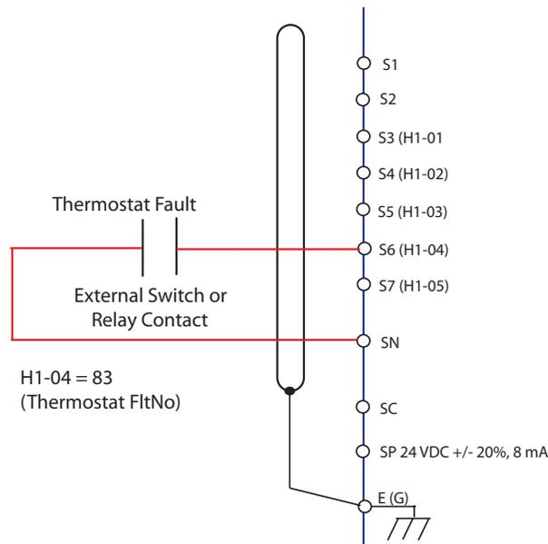
**Figure 47 Wiring Diagram**
