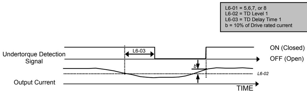
**Figure 57 Trq Det 1 N.C. Timing Diagram**
