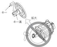
カップリングの取付け時は、軸に衝撃を加えないように注意してください。
