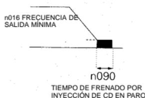
Cuando se especifica la marcha sin motor hasta detenerse en la selección del método de paro (n005), no opera el frenado por inyección de CD.
