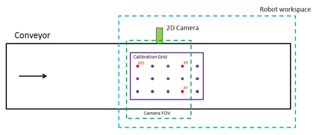
FIGURE 27 CALIBRATION GRID INSIDE ROBOT WORKSPACE AND REPRESENTATION OF POINT OO
