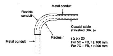
Figure 6.5 Metal Conduit Bending
