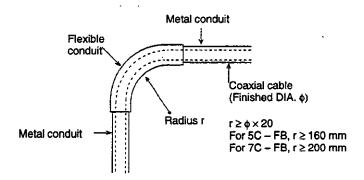
Figure 4.5 Metal Conduit Bending
