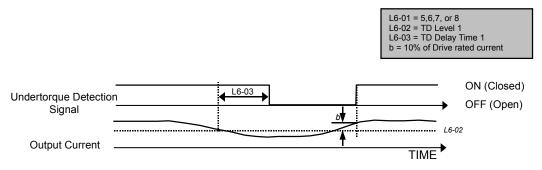
Fig. 46 Trq Det 1 N.C. Timing Diagram
