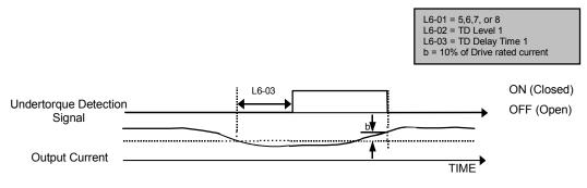
Fig. 44 Trq Det 1 N.O. Timing Diagram
