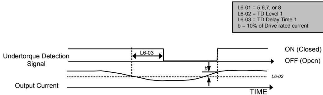
Fig. 46 Trq Det 1 N.C. Timing Diagram
