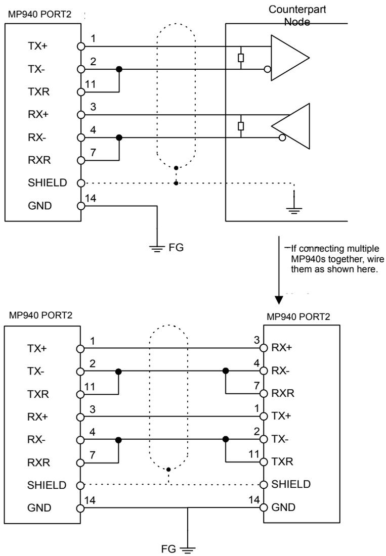
**Figure 5.5: Wiring Diagram**
