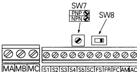
\* Se puede cambiar el SW7 de acuerdo con la polaridad de la señal de entrada de frecuencia (de S1 a S5).
