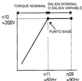
• **Incremento automático del torque en todo el rango**
