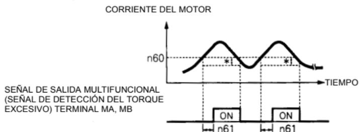
\* Ancho de liberación de detección de torque excesivo (histéresis) se configuran aprox. 5% de la corriente nominal del inversor.
