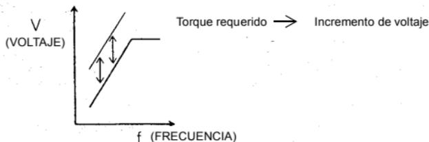
Normalmente, no es necesario ningún ajuste para la ganancia de compensación del torque (configuración de fábrica para el n63: 1.0). Cuando sea mucha la distancia de cableado entre el inversor y el motor o cuando el motor genere vibración, cambie la ganancia automática de compensación del torque. En estos casos, ajustar el patrón V/f (de n09 a n15) también puede resultar beneficioso.
