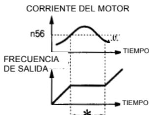
\* Detiene la aceleración para evitar que el motor pierda velocidad.
