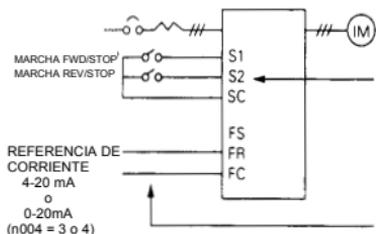
Configura marcha/paro y marcha FWD/REV con el dispositivo de conmutación conectado a la terminal del circuito de control.
