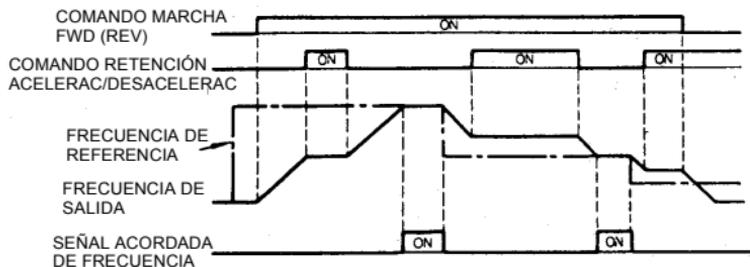
Note: No funciona el motor cuando se introduce el comando de marcha adelante/en reversa (FWD/REV) junto con el comando de detención acelerac/desacelerac. Sin embargo, cuando el límite inferior de la frecuencia de referencia (n31) está configurado mayor que o igual a la frecuencia mínima de salida (n14), el motor opera al límite inferior de frecuencia de referencia (n31).
