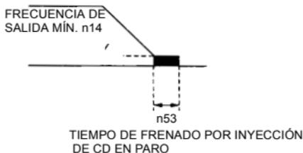
Cuando se selecciona marcha libre del motor hasta detenerse como selección del método de detención (n04), no opera el frenado con inyección de CD en paro.
