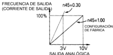
Escala el nivel de señal de voltaje de salida analógica en 100% de la frecuencia de salida (corriente de salida).
