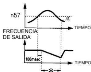
\* Reduce la frecuencia para evitar que el motor pierda velocidad.
