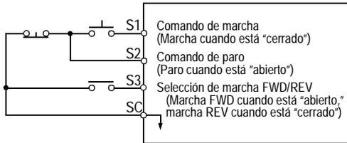
**Figura 49** Función de la terminal con selección de la secuencia de 3 cables (configuración: "1")
